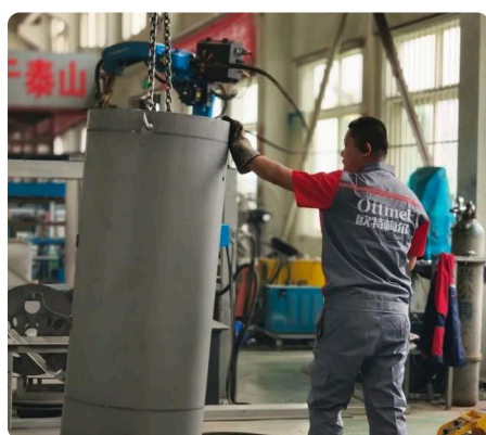
Soudage robotisé des cuves
